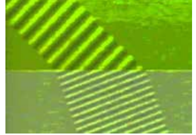
الشكل (17): انكسار موجات سطح الماء المستوية.
