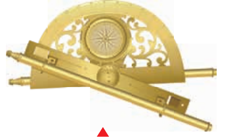
الشكل (7): الأسطرلاب الذي يقيس ارتفاع النجوم عن الأفق.
