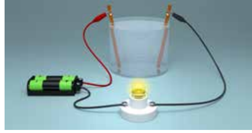
الشكل (7): المحاليل الموصلة في الدارات الكهربائية.
