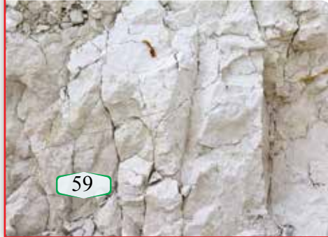
▼ الصخر الجيري النقي: يُستخدم في صناعة الأسمنت.
