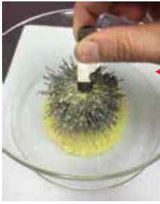
▲ فصل برادة الحديد عن عنصر الكبريت باستخدام المغناطيس.
