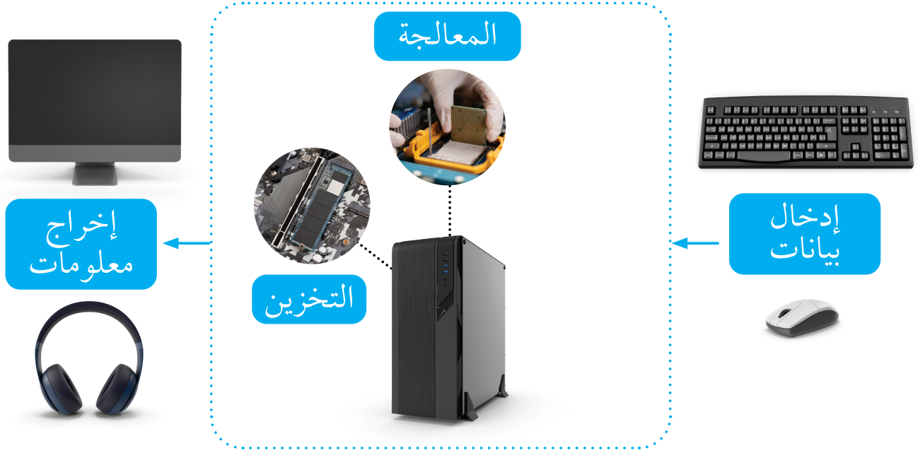
الشكل (1-1): رسم توضيحي لمبدأ عمل جهاز الحاسوب.
